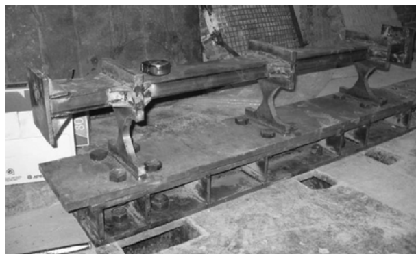
شکل ۵. تصویر یک نمونه آزمایشگاهی برشگیر فولادی.
